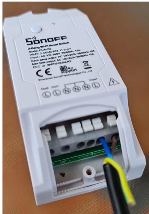
Figura 19 - Conexión eléctrica SOnOff Dual R4
